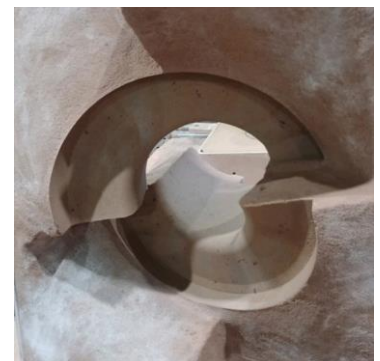
Sección superior, inferior y media del taladro saliente de un molde de arena antes de verter el líquido.
