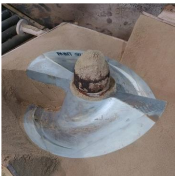
Sección superior, inferior y media del taladro saliente de un molde de arena antes de verter el líquido.
