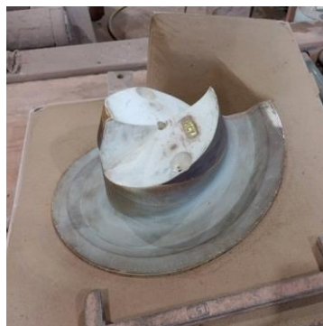
Sección superior, inferior y media del taladro saliente de un molde de arena antes de verter el líquido.
