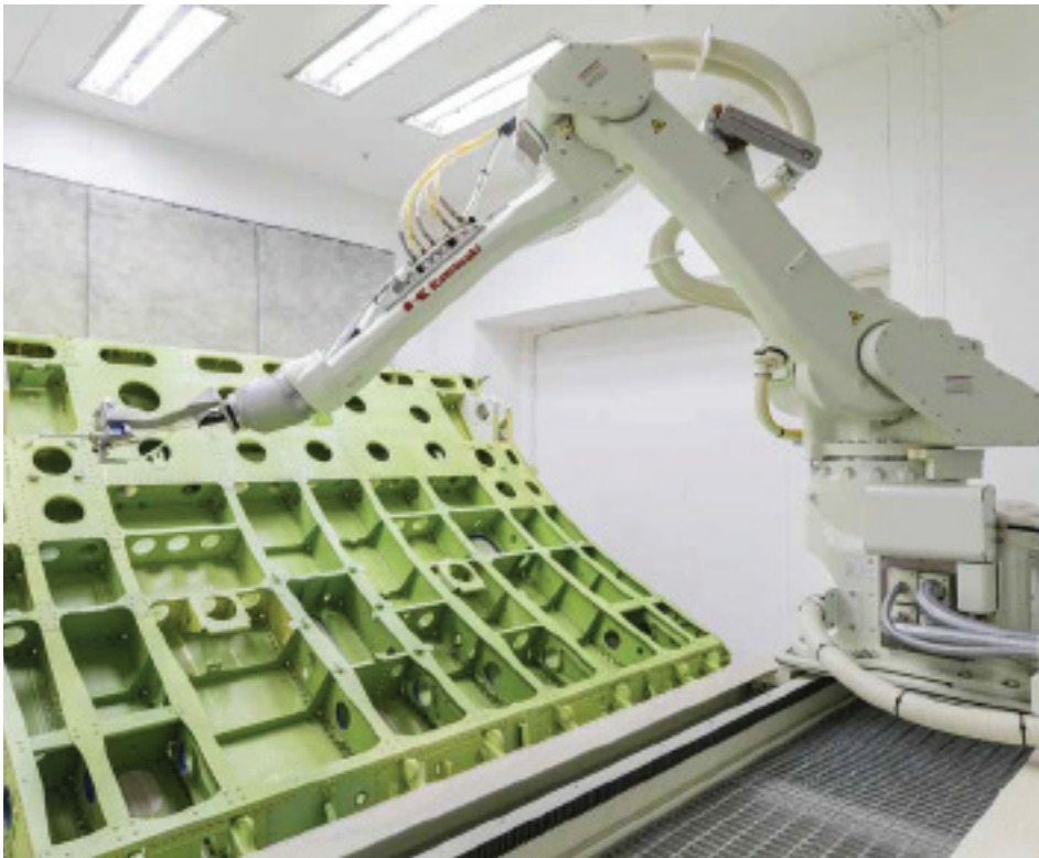
Die Herstellung von Boeing 777X-Ladetüren mit den automatisierten Fertigungssystemen von Kawasaki.
