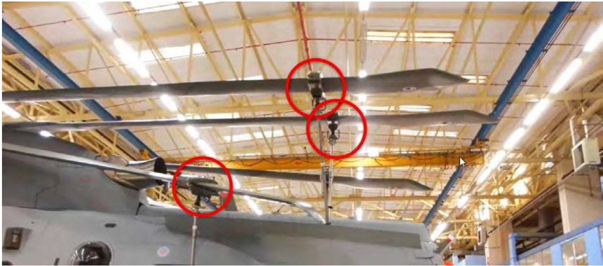
Bild: Hauptrotorblatthalterungen für den AgustaWestland AW101 – Leonardo helicopters.
